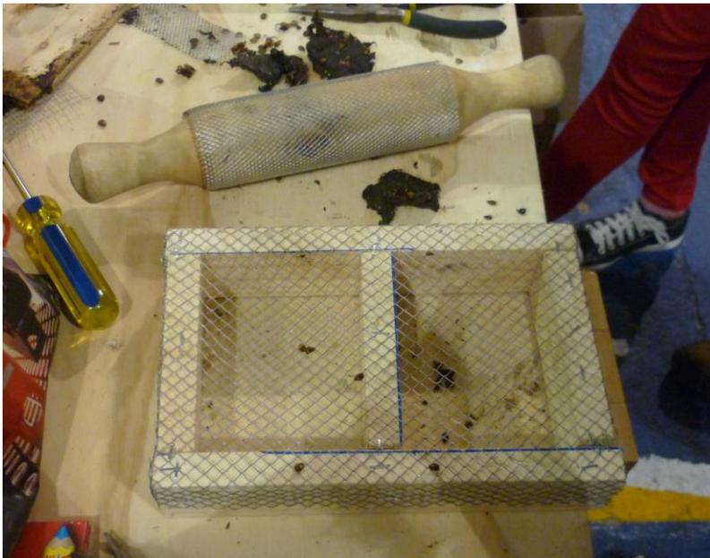
\*Modelo para la separación de la semilla por fricción. Rodillo con malla de 2mm, superficie plana con malla de 4mm.
