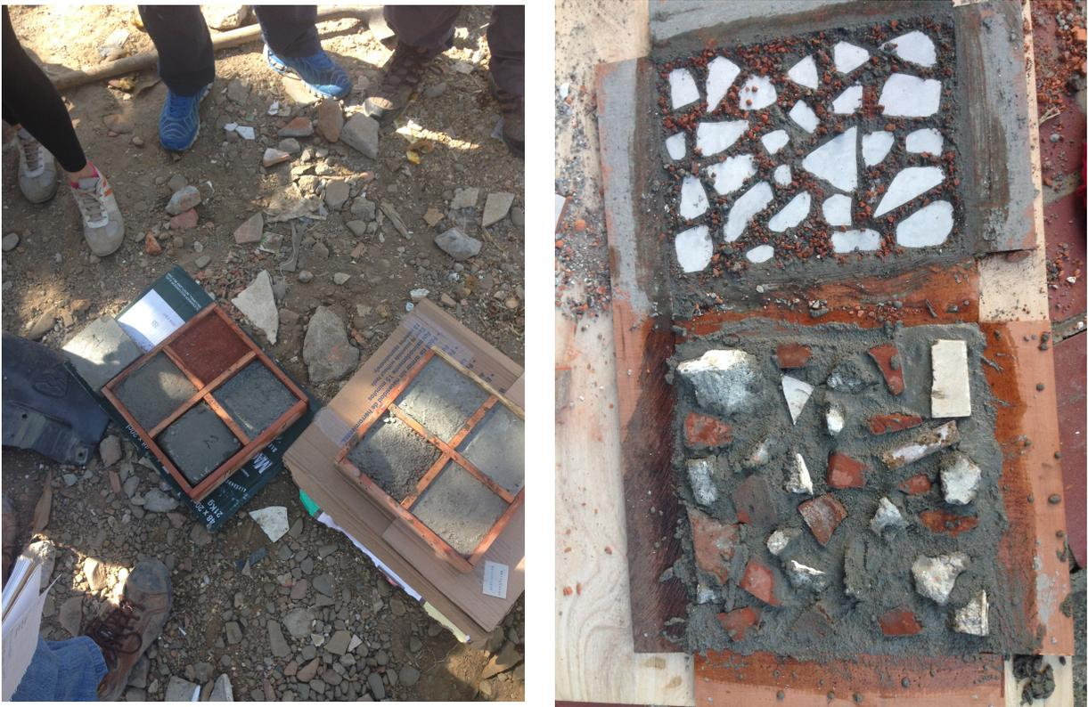
**Figura 2.** Pruebas iniciales de elaboración de materiales a partir de escombros.
